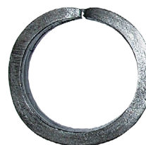
ZKOUŠKA ROZŠÍŘOVÁNÍM PRSTENCE
