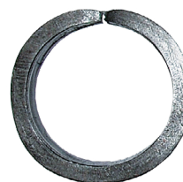
ZKOUŠKA ROZŠÍŘOVÁNÍM PRSTENCE
