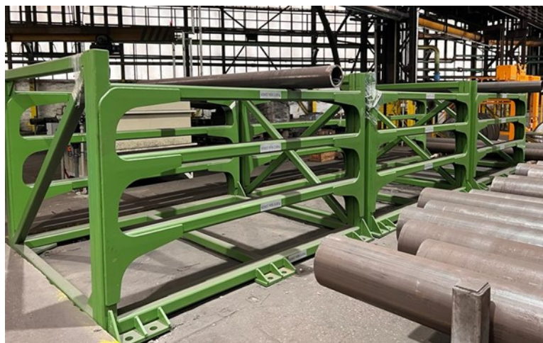
Víceragálové stojany pro uskladnění etalonů
